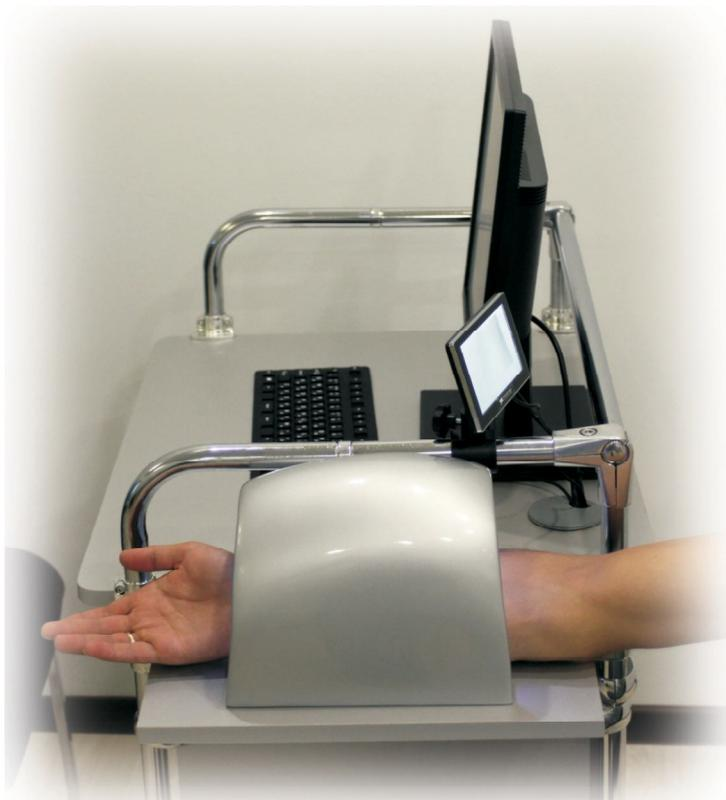
Фоторегистрирующий блок имеет возможность получать изображения в видимом диапазоне, ближнем УФ диапазоне, а также в ближнем ИК диапазоне.
